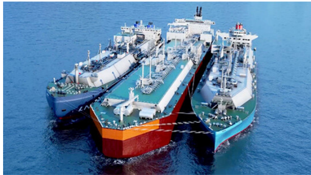
그림 6 FSU와 LNG 환적 작업(MOL)
