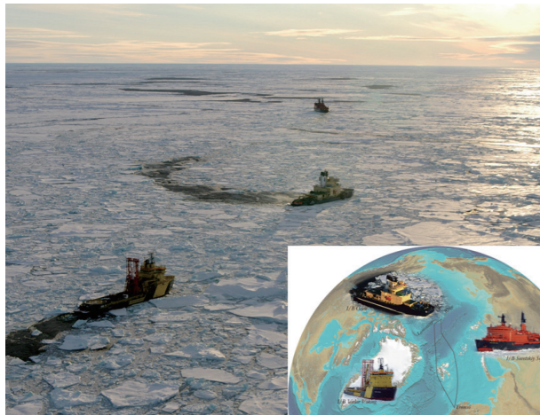
2004년 8월 북극해 로모노소프 해령 시추를 위한 3대의 시추 선단으로 구성된 Vidar Viking(근거리) 시추하는 동안 스웨덴 쇄빙선 RV Oden(가운데)과 러시아 핵추진 쇄빙선 Sovetskiy Soyuz(원거리)의 지원으로 유빙의 위험으로부터 안전하게 시추가 가능하였음 (Photo from Martin Jakobsson, 2004년 8월 30일)
